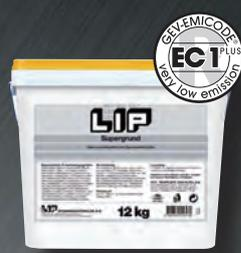
LIP Supergrund ist eine Quarzsand-modifizierte, lösemittelfreie Spezialhaftbrücke für Wand- und Bodenflächen mit hoher Verbundhaftfestigkeit auf glatten und gefügedichten Untergründen. LIP Supergrund dient als Haftbrücke und Grundierung auf nicht saugenden und saugenden Untergründen, im Innen- und Außenbereich, vor der Verlegung von Fliesen und dem Auftragen von Spachtelmasse.
