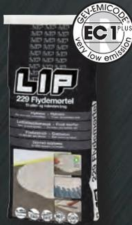
LIP 229 ist eine selbstnivellierende Spachtelmasse auf Zementbasis, die zum Spachteln und Ausgleichen von Bodenflächen aus Beton, Putzschichten sowie keramischen Fliesen, Klinkern u.v.a. draußen und drinnen verwendet wird. LIP 229 kann mit einer Pumpe aufgetragen werden und eignet sich bestens in Verbindung mit Fußbodenheizungssystemen. LIP 229 kann auch in nassen Zonen und anderen ständig wasserbelasteten Bereichen verwendet werden.
