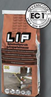
LIP 215 Bodenspachtelmasse wird zum Nivellieren, Ausgleichen und Feinspachteln von Beton, Putzschichten, Naturstein, keramischen Fliesen, Metall, Gussasphalt, Klinkern, Holz u.v.a. mit einer Schichtdicke von 0 mm bis 10 mm verwendet. Eignet sich bestens in Verbindung mit Fußbodenheizungssystemen. Bei Nivellierungsarbeiten auf beweglichen Unterlagen wird LIP Multibinder eingebracht zur Erhöhung der Elastizität.
