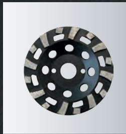
Kurz-Lang-Wechselsegmentiert, gelötet. Flache Bauform. Sehr schneller, kühler Schliff, sauberes Schliffbild, durch Spezial-Segmentierung kein Zusetzen der Segmente, ideal für Betonschleifer geeignet.
