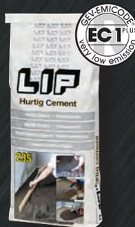
LIP 235 ist ein Spezialzement zur Herstellung von frühbelastbarer Bodenausgleichmasse Estrich für feste sowie schwimmende Konstruktionen und Reparaturarbeiten, wo der Untergrund in kürzester Zeit verlegereif sein soll. Entwickelt gute Festigkeitseigenschaften, nach 3,5 Std. Spachtelbar und verlegereif für Fliesen/ Klinker nach 4,5 Std..
